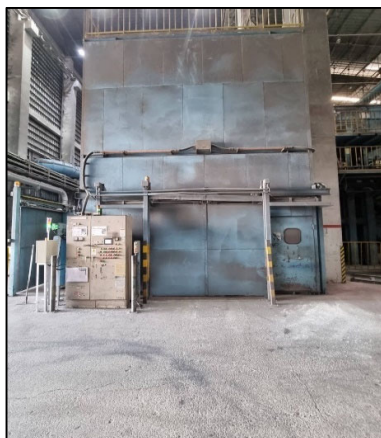
ภาพที่ 2.9 ห้องควบคุมเสียงเครื่องขุดชิ้นงานอัตโนมัติ
