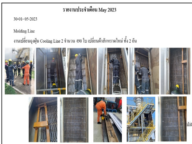
ภาพที่ 2.6 เปลี่ยนถุงกรองของระบบ Bag filter
